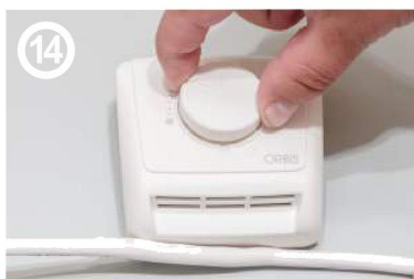
14 Установить на место маленькую крышечку - вертушек. Она должна войти в паз. (если она у Вас не устанавливается, не стоит прикладывать много усилий, просто поищите положение, в котором она легко установится)
